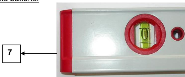
Rimuovete il tassello in gomma a pressione. Potete facilmente sostituire la batteria e rimontare il tassello (7) a semplice pressione.
